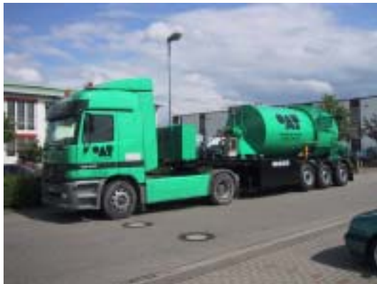
16m 3 Fahrmischer für Schnellbeton
