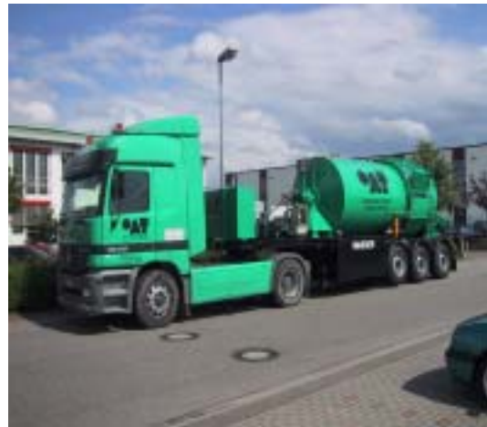
16 m 3 -Fahrmischer für Schnellbeton
