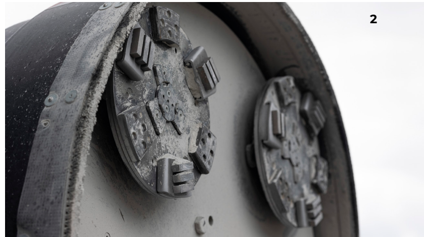
1 digitale Anzeige der Steuerung | 2 Schleifkopf mit Trägerplatte und Werkzeugen
